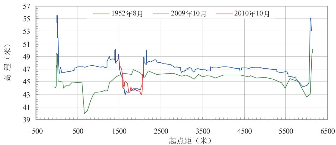
图22 黄河孙口断面套绘图
